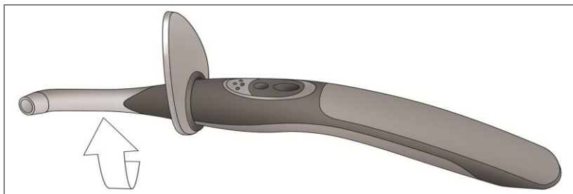
Obrázek 8 – Otočení přípojky lampy LED Demi Ultra
